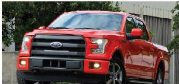
Nova F150 – Primeiro utilitário construído com chassis e carroceria de alumínio
