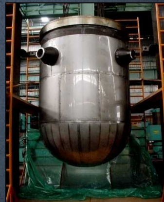
Vaso de Pressão do Reator
